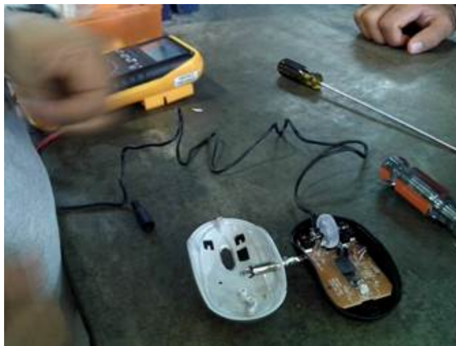
Imagen 3. Mouse con perforación para colocar la conexión del plug a botón externo.
