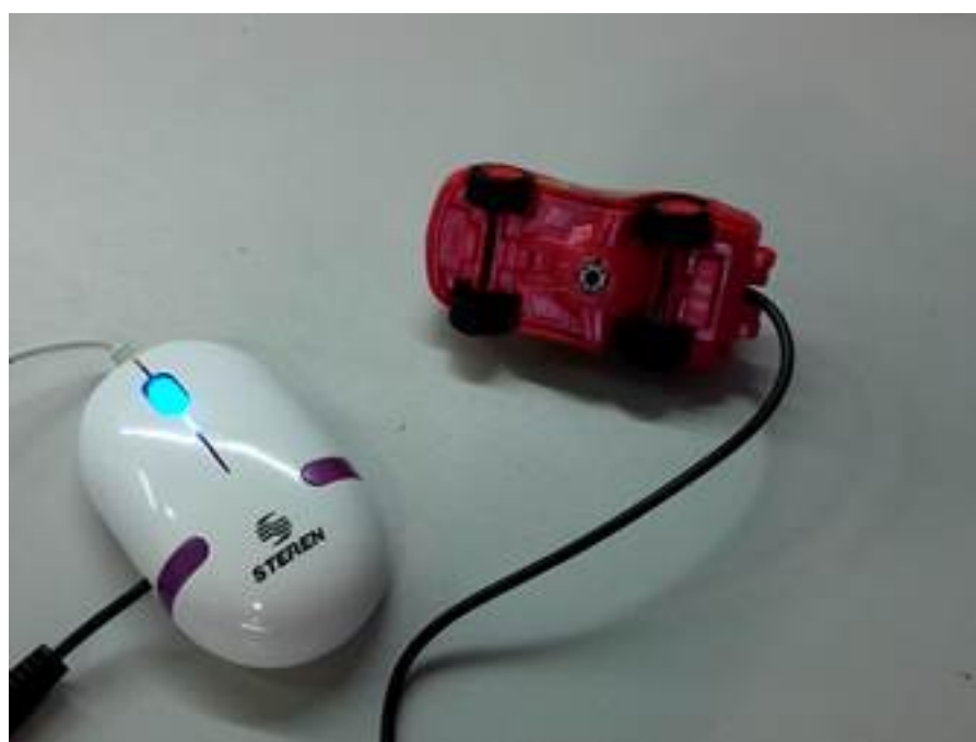
Imagen 4. Mouse adaptado con juguete al que se incluyó botón tipo switch.
